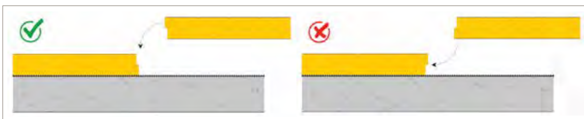
Afbeelding 28: Montage van isolatieplaten met spinning (links: correcte toepassing, rechts: foutieve toepassing)
